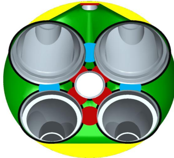
4. ábra: Égéstér falvastagságának szemléltetése [5]
